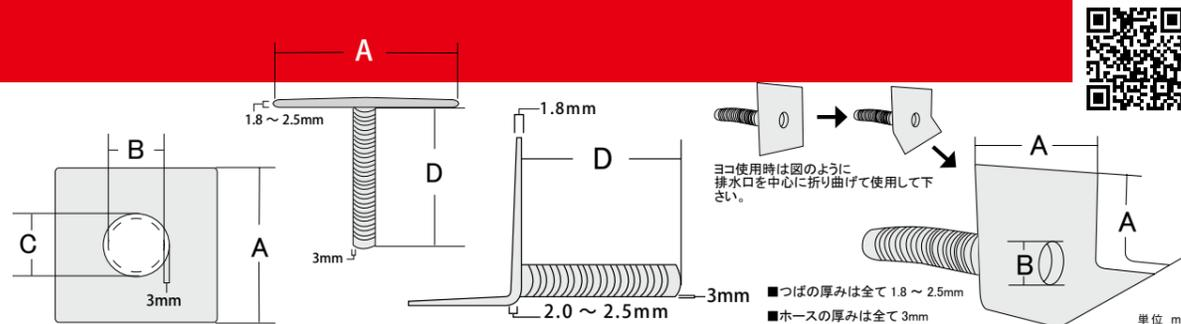
ヨコ使用時は図のように排水口を中心に折り曲げて使用して下さい。
