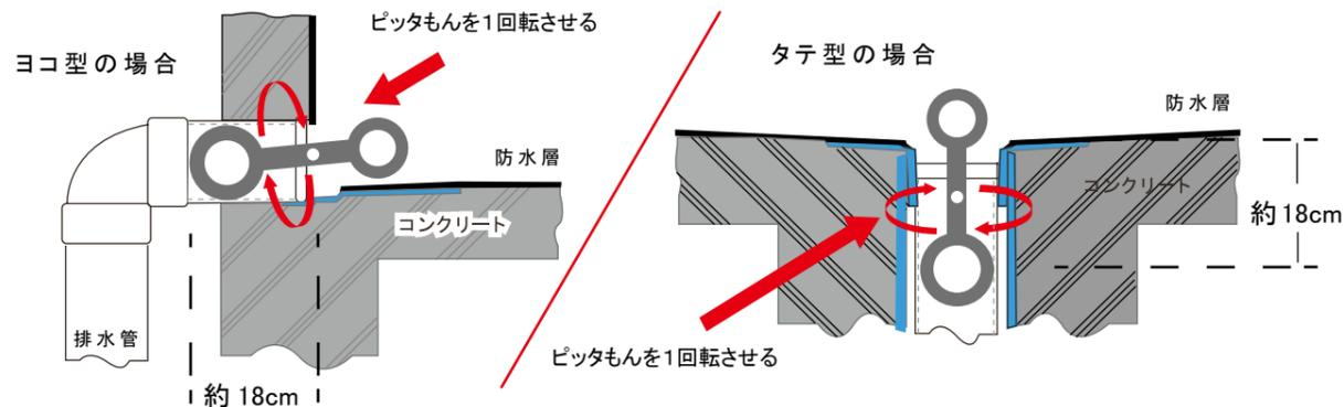
3. 上記工程にて、施工する排水管に適合したピッタ蒙ゲージに打刻されているサイズ表記を確認し、適切なサイズの孫悟空ドレンを選びます。
